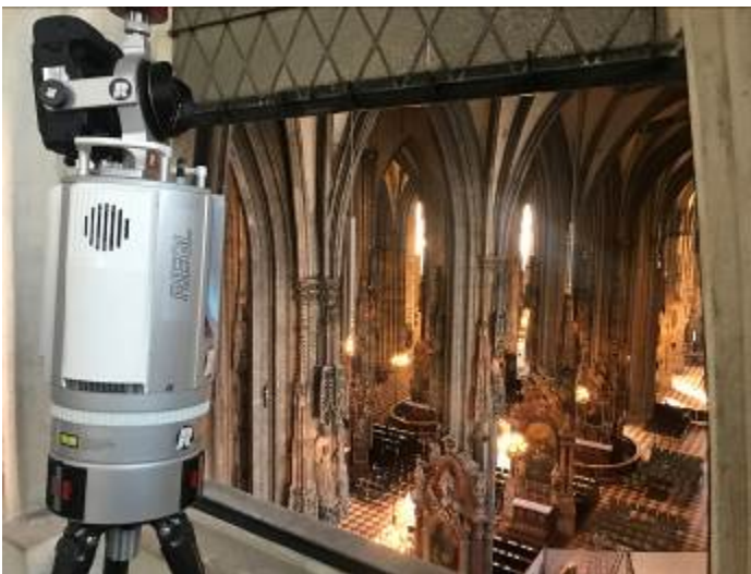
Der RIEGL VZ-400i Laserscanner bei der Datenaufnahme im und vor dem Stephansdom (Fotos RIEGL)
