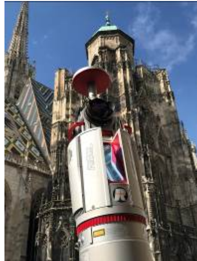
Der RIEGL VZ-400i Laserscanner bei der Datenaufnahme im und vor dem Stephansdom (Fotos RIEGL)
